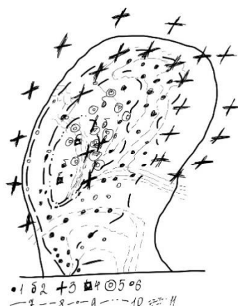
Рисунок 1. Схема размещения скважин для разработки пласта барьерным заводнением, где 1-6 – нефтяные, газовые, нагнетательные, наблюдательные, контрольные, выбывшие из эксплуатации скважины, 7, 8 – внешний и внутренний контуры нефтеносности, 9, 10 – внешний и внутренний контуры газоносности, 11 – изоденситы попутной и закачиваемой воды
